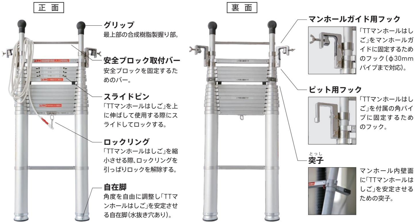
※マンホールガイド用フック、ピット用フックは用途に応じて付け替えて使用します。
